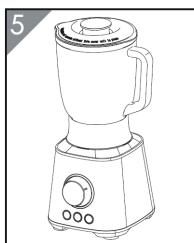
El aparato está equipado con un mecanismo de protección. Si la tapa o el vaso no están colocados correctamente o el soporte de las cuchillas no está bien encajado, la batidora no se pondrá en marcha. Para fijar el vaso completamente a la base, siga estos pasos:
