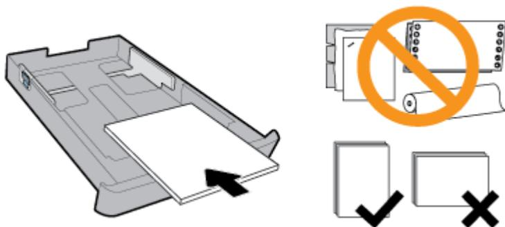
Ujistěte se, že je stoh papíru zarovnan s odpovídající čarou formátu papíru na přední straně zásobníku. Kromě toho se ujistěte, že stoh papíru nepřesahuje označení výšky stohu na pravém okraji zásobníku.
