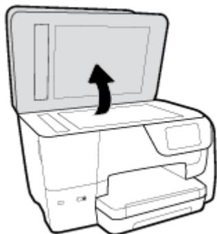
2. Očistěte sklo skeneru a spodní stranu víka měkkým hadříkem, který nepouští vlákna, navlhčeným jemným prostředkem na čištění skla.
