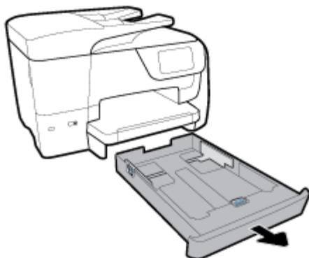
2. Zkontrolujte oblast vstupního zásobníku pod tiskárnou. Odstraňte uvíznutý papír.
