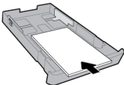
Ujistěte se, že je stoh papíru zarovnan s odpovídající čarou formátu papíru na přední straně zásobníku. Kromě toho se ujistěte, že stoh papíru nepřesahuje označení výšky stohu na pravém okraji zásobníku.
