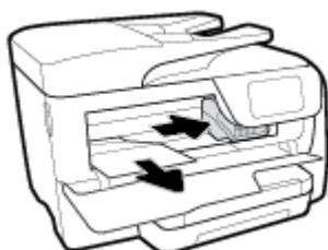
4. Pokud je to nutné, přesuňte držák v tiskárně zcela vlevo a odstraňte zbývající uvíznuté či potrhane kusy papíru.
