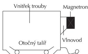
V mikrovlnné troubě je energie přeměněna na mikrovlny pomocí **MAGNETRONU**
