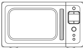
Mikrovlny se odrazí od kovových stěn a od kovové sítěk dveří.
