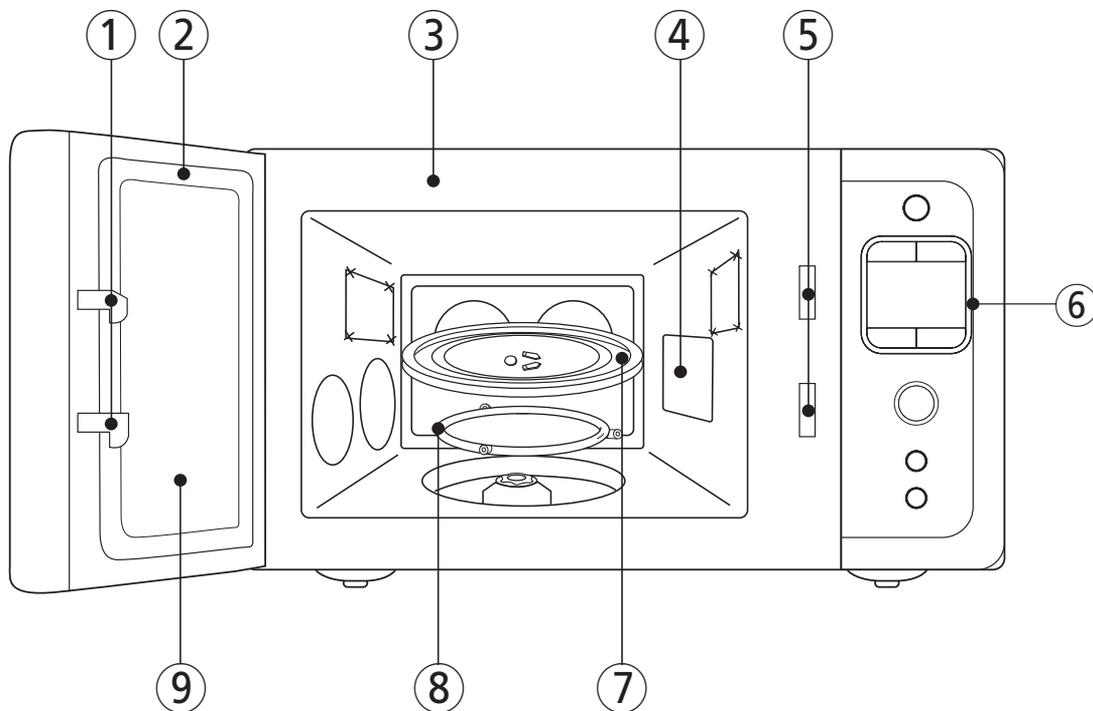
① **Bezpečnostní uzávěry dvířek** - po uzavření dvířek budou dvířka automaticky zajištěna. Otevřením dvířek za provozu trouby bude vypnut magnetron (zdroj mikrovlnné energie).
