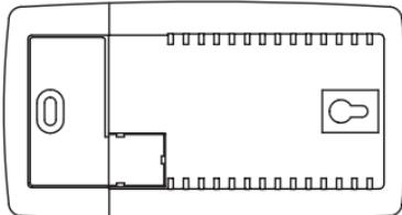
Efectuați în perete două găuri cu diametrul de 6 mm.
