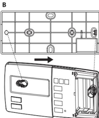
Poznámka: Pokud je stěna dřevěná, nemusíte používat hmoždinky. Vyralte dva otvory o průměru 2,7 mm namísto otvorů o průměru 6 mm.
