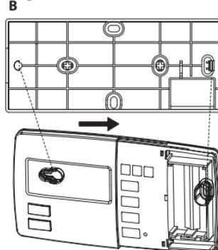
*Bemerkung: Bei einer Holzwand müssen keine Dübel benutzt werden. In die Wand zwei Löcher mit Durchmesser 2,7 mm anstelle 6 mm bohren.*
