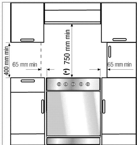
Mezi přístrojem a kuchyňskými stěnami a nábytkem musí zůstat bezpečnostní vzdálenost. Viz obrázek (hodnoty v mm).
