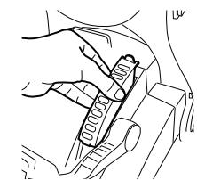
Odstraňte filtr z komory. Opláchněte pod teplou vodou, abyste odstranili nečistoty. Nechte jej zcela vyschnout před návratem do čističe.
