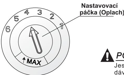
Dávkovač oplachovacího prostředku má šest poloh nebo čtyři polohy. Vždy začínejte s dávkovačem nastaveným v poloze „4“. Pokud jsou na nádobí skvrny a špatně schně, zvýšte množství dávkovaného oplachovacího prostředku: vyjměte víčko dávkovače a pootočte kolečkem na „5“. Pokud nádobí stále špatně schně nebo jsou na něm skvrny, nastavte kolečko na další vyšší hodnotu, dokud není nádoby beze skvrn. Doporučené nastavení je „4“. (Tovární hodnota je „4“.)
