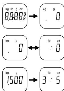
5 Sprawdzić, czy wyświetlacz pokazuje „0”. Jeśli nie, wyzerować urządzenie, naciśkając przycisk ON/ZERO. Następnie zważyć składniki, wsypując je bezpośrednio do miski/dzbanka. Po ukazaniu się wagi składników na wyświetlaczu naciśnąć przycisk ON/ZERO, by ponownie wyzerować wyświetlacz „0”. Dodawać kolejne składniki (ich waga będzie wyświetlana na wyświetlaczu). Czynność powtórzyć, aż wszystkie składniki zostaną zważone.
