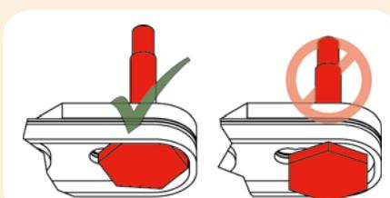
Bei Verwendung auf LGA1366 und LGA1156/1155 Mainboards entfernen Sie bitte die Gummi-Einlage. Stellen Sie sicher, dass die Gummi-Einlage für die Verwendung auf LGA775 Mainboards eingesetzt ist.
