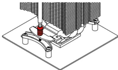
Achtung: Ziehen Sie die Schrauben bis zum Anschlag an.
