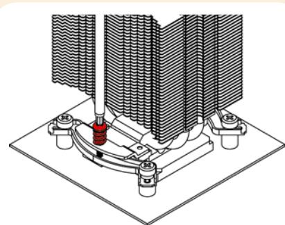
**Achtung:** Ziehen Sie die Schrauben bis zum Anschlag an.
