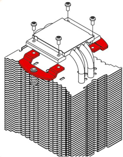
**Achtung:** Stellen Sie sicher, dass Sie die Befestigungswinkel korrekt montiert haben:
