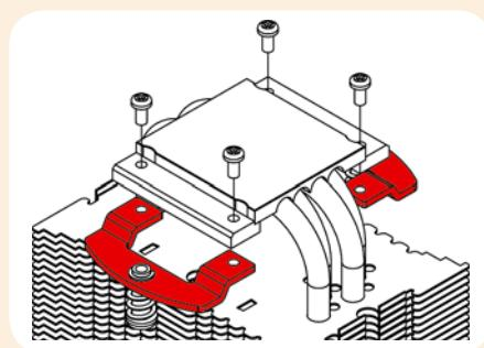
**Achtung:** Stellen Sie sicher, dass Sie die Befestigungswinkel korrekt montiert haben:
