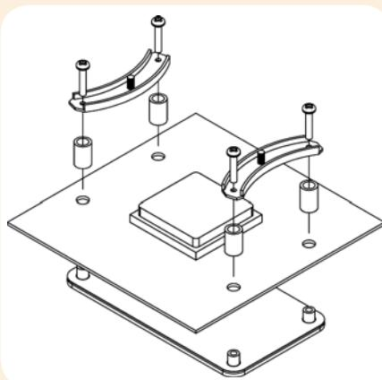
**Achtung:** Stellen Sie sicher, dass die Biegungen der Montagebrücken nach innen zeigen.
