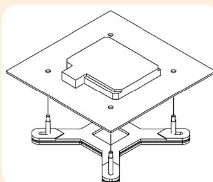
**Achtung:** Beachten Sie auf LGA1156/1155, dass die zwei Ausnehmungen der Küller-Backplate auf die zwei Schrauben der Mainboard-Backplate ausgerichtet sind.
