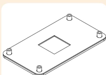
**Achtung:** Das SecuFirm2™ Montagesystem benötigt eine Backplate, die bei den meisten AM2/AM2+/AM3 Mainboards ab Werk vorinstalliert ist.
