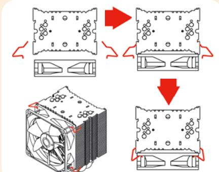
Für zusätzliche Performance (ca. 1-3°C) montieren Sie bitte den zweiten NF-B9 Lüfter, so dass er die Luft von der Rückseite des Kühlers absaugt. Stellen Sie sicher, dass beide Lüfter in die gleiche Richtung blasen.
