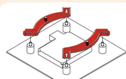
**Achtung:** Wählen Sie die Ausrichtung der Montagebrücken gemäß der gewünschten Orientierung des Kühlers.
