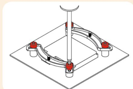
**Achtung:** Ziehen Sie die Schrauben bis zum Anschlag an.
