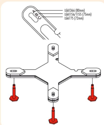
**Achtung:** Bitte stellen Sie sicher, dass alle vier Stutzen in die korrekten Löcher eingesetzt und zur Gänze eingeschoben wurden.
