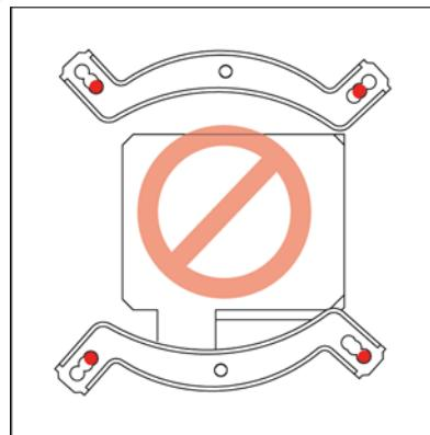
Fixieren Sie die Montagebrücken mit den 4 Daumenschrauben.
