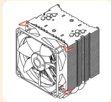
Für zusätzliche Performance (ca. 1-3°C) montieren Sie bitte den zweiten NF-B9 Lüfter, so dass er die Luft von der Rückseite des Kühlers absaugt. Stellen Sie sicher, dass beide Lüfter in die gleiche Richtung blasen.
