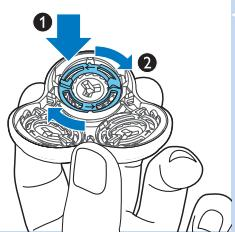
**Примечание.** При установке бритвенных головок и присоединении фиксирующих колец удерживайте держатель бритвенных головок в руке. Не оставляйте держатель бритвенных головок на рабочей поверхности во избежание повреждений.
