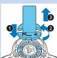
**2** Helyezze rá a rögzítőgyűrű-tartót a rögzítőgyűrűre (1), fordítsa el az óramutató járásával ellentétesen (2), majd emelje le a borotvafejről (3). Vegye ki a rögzítőgyűrűt a rögzítőgyűrű-tartóból, majd ismételje meg a folyamatot a többi rögzítőgyűrűvel is.
