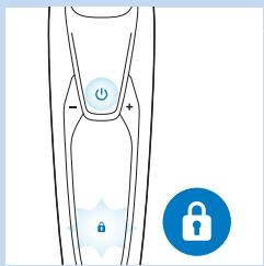
Докато активирате заключването при пътуване, символът за заключване при пътуване свети в бяло постоянно. Когато заключването при пътуване е включено, самобръсначката издава звуков сигнал и символът за заключване при пътуване премигва.
