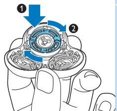
**Napomena:** Držite držač glave za brijanje u ruci prilikom ponovnog umetanja glava za brijanje i vraćanja prstenova za pričvršćivanje. Nemojte stavlјati držač glave za brijanje na površinu dok to činite, jer to može uzrokovati oštećenja.
