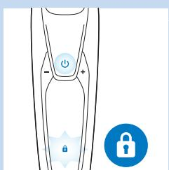
Символът за заключване при пътуване премигва, след което започва да свети непрекъснато.
