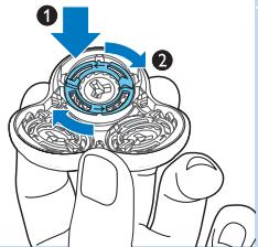
**Примітка:** Встановлюючи бритвені головки і фіксуючі кільця, тримайте тримач бритвеної головки у руці. Виконуючи ці дії, не ставте тримач бритвеної головки на поверхню, оскільки це може спричинити пошкодження.
