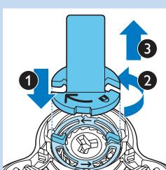
**2** Встановіть тримач фіксуючого кільця на фіксуюче кільце (1), поверніть його проти годинникової стрілки (2) і зніміть його з бритвою головки (3).
