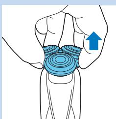
**2** Вийміть тримач бритвених головок із нижньої частини бритвеного блока.
