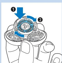
*Upozornenie: Keď pripájate holiace hlavy a príderné krúžky späť, držte držiak holiacej hlavy v ruke. Neumiestňujte pri tomto úkone držiak holiacej hlavy na povrch, inak by sa mohol poškodiť.*
