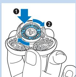
*Opomba: Nosilec brivne glave držite v roki, ko ponovno vstavite brivne glave in namestite pritrdilne obročke. Nosilca brivne glave pri tem ne postavljajte na površino, ker ga lahko poškodujete.*
