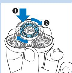
*Napomena: Držite držać glave za brijanje u ruci prilikom ponovnog umetanja glava za brijanje i vraćanja prstenova za pričvršćivanje. Nemojte stavlјati držać glave za brijanje na površinu dok to čnite, jer to može uzrokovati oštećenja.*
