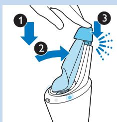
3 Поместите бритву в держатель (1), наклоните бритву назад (2) и нажмите на верхний колпачок для подключения к бритве (должен прозвучать щелчок) (3).
