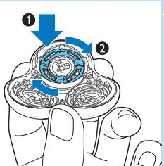
**Upozornenie:** Keď pripájate holiace hlavy a prídržné krúžky späť, držte držiak holiacej hlavy v ruke. Neumiestňujte pri tomto úkone držiak holiacej hlavy na povrch, inak by sa mohol poškodiť.
