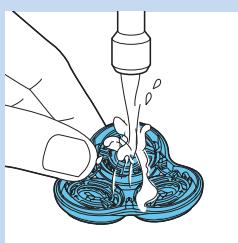
**3** Nosič holiacej hlavy opláchnite pod teplou tečúcou vodou.
