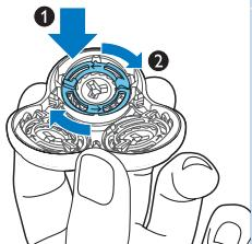
**Uwaga:** Przytrzymaj uchwyt głowicy golącej w dłoni podczas ponownego zakładania głowic golących i mocowania pierścieni zabezpieczających. W trakcie wykonywania tych czynności nie umieszczaj uchwytu głowicy golącej na żadnej powierzchni, ponieważ może to spowodować uszkodzenia.
