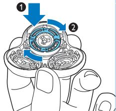
**Opomba:** Nosilec brivne glave držite v roki, ko ponovno vstavite brivne glave in namestite pritrdilne obročke. Nosilca brivne glave pri tem ne postavlajte na površino, ker ga lahko poškodujete.
