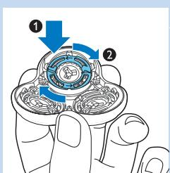
*Uwaga: Przytrzymaj uchwyt głowicy golącej w dłoni podczas ponownego zakładania głowic golących i mocowania pierścieni zabezpieczających. W trakcie wykonywania tych czynności nie umieszczaj uchwytu głowicy golącej na żadnej powierzchni, ponieważ może to spowodować uszkodzenia.*
