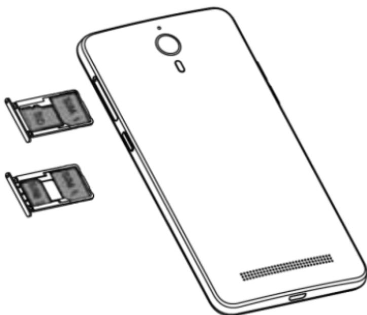
2. Ziehen Sie den Kartenschacht vorsichtig heraus. Bitte eine Micro SIM-Karte in Steckplatz 1 einsetzen, und eine Nano SIM- oder Micro SD (T-Flash)-Karte in Steckplatz 2.
