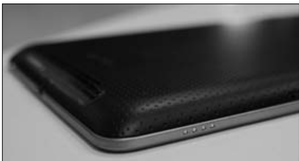
Obrázek 1.4 Dokovací konektor v podobě několika kontaktů
