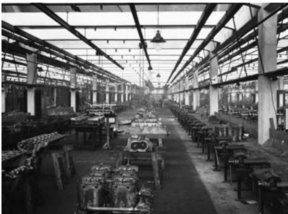
Pohled na montáž agregátů, vpředu čtyřválců lehčího typu traktoru „U“, v pozadí kliková skříň šestiválce „Z“. Bloky válců a hlavy byly pro oba typy společné
