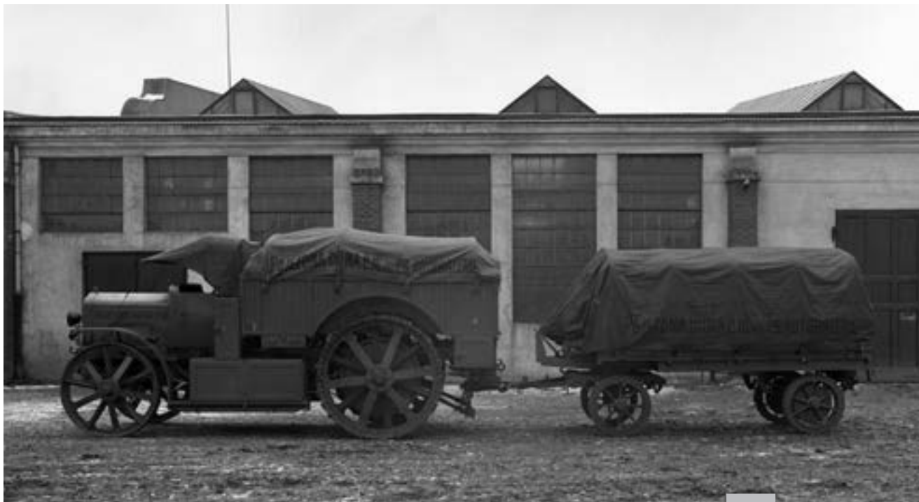
Pojízdna dílna československých autobaterií. Na nádvoří plzeňské Škodovky stojí jedna z dokončených dílů na podvozku typu „U“ s přívěsem
