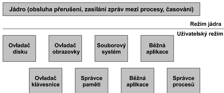
Obrázek 2.1: Schéma operačního systému založeného na mikrojádro
