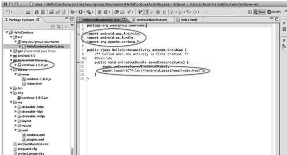
Obrázek 12: Úprava hlavního Java souboru projektu pro načtení souboru index.html z adresáře assets/www/ a přidání jar knihovny PhoneGap do projektu Android
