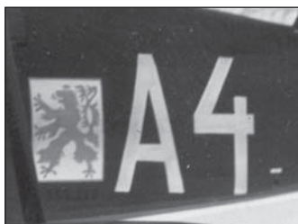
Jedna z podob typového označení a sériového čísla na trupu a na vzpěrách letadel firmy Aero (A.32.9)
