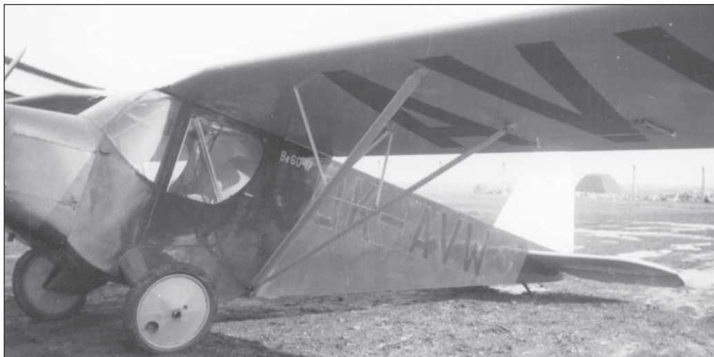
Příklad zápisu typu a sériového čísla pod křídlem Be.60.17
