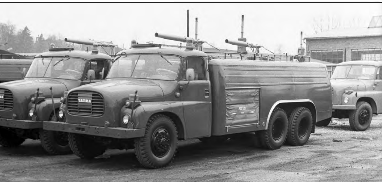
CAS 32 na podvozku Tatry 148 byla schopná nasazení v těžším terénu.
