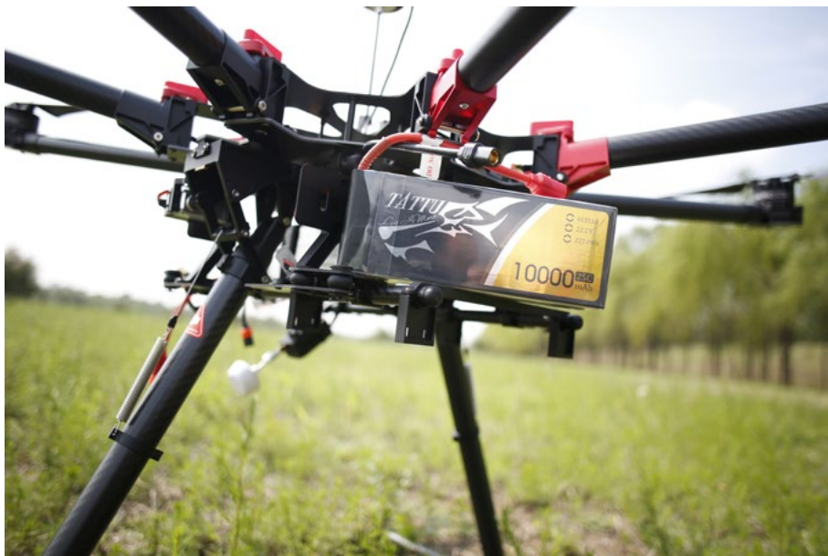
Obrázek 11: Pohonná baterie dronu s uvedením kapacity, počtu článků a napětí
