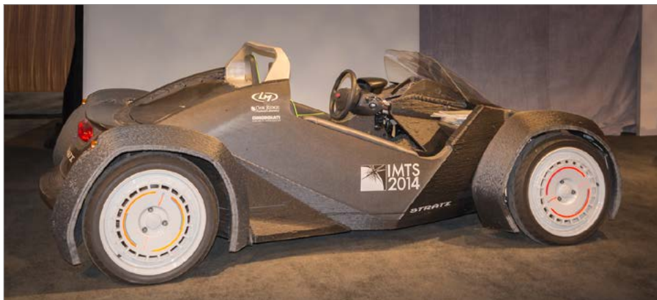
Obrázek 3.1: Detroit, leden 2012, automobil Strati firmy Local Motors – futuristické auto vyrobené pomocí 3D tisku metodou rychlého prototypování (Steve Lagreca, Shutterstock.com )
