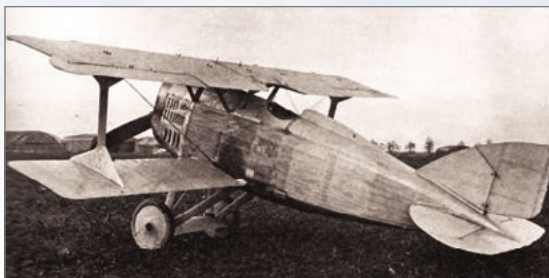
◀ Původní provedení Aera Ae-04 s čelním chladičem
