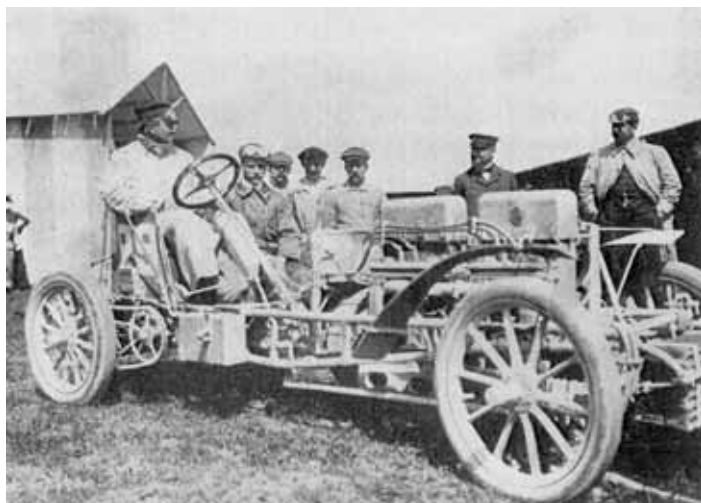
Obr. 1.12 Trubková konstrukce rámu vozu Gobron Brillié. Vůz měl motor s protiběžnými písty o objemu 13,5 litru. Výkon motoru byl 82 kW (110 k)
