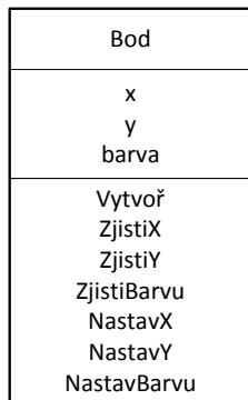
Obrázek 1.4: Možné znázornění třídy Bod v modelovacím jazyce UML
