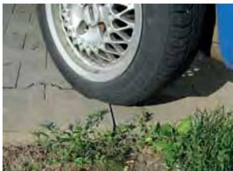
Riziko poškození pláště: špatné parkování na obrubníku
