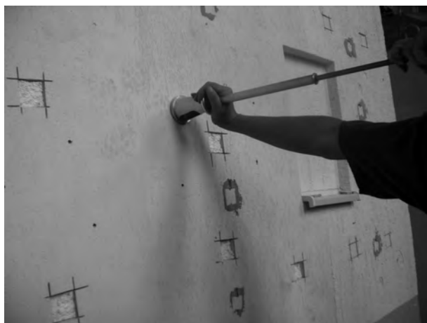
Obr. 5 Vlastní provádění Perfotestu
