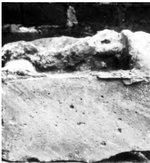
■ Vzduchové bubliny v litém bloku štuky, z něhož byla vyřezána hlavice (klášter Ebsdorf)
