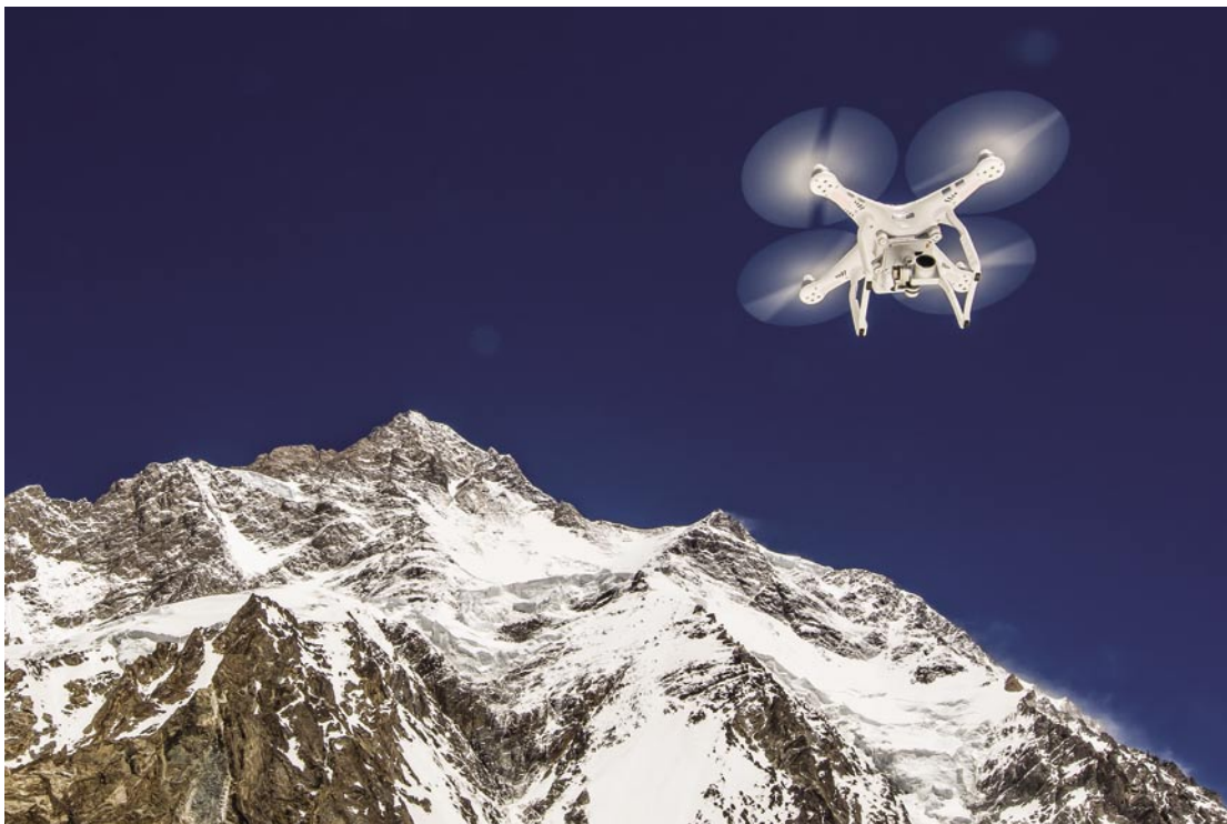
K2, Pákistán, 3. července 2016 Dron DJI Phantom 3 Advanced letící v maximální dosažitelné nadmořské výšce stanovené výrobcem (6000 m n. m.). Pro let v ještě vyšších polohách musí mít drony upravený průměr i stoupavost vrtulí, což u sériově vyráběných dronů, jako je tento, nemusí být vždy možné. [P]]
