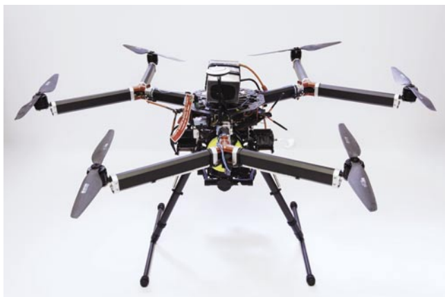
Velká filmová hexakoptéra na uhlíkovém rámu o třech ramenech se skládacím podvozkem. [VI]
