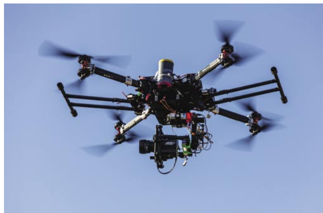
Velká filmová oktokoptéra o čtyřech ramenech se zavěšeným gimbaelem MOVI a profesionální kamerou. Na straně je patrný padákový systém. [VI]
