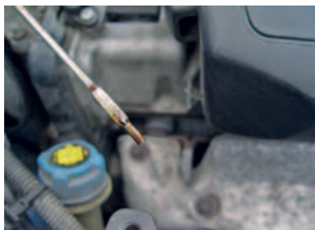
Na měrce je vidět, kam dosahuje hladina oleje
