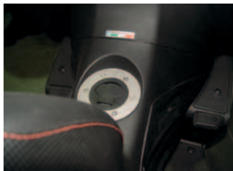
Snadno přístupné, uzamykatelné víčko nádrže je umístěno na krytu středové části rámu, mezi podlážkami
