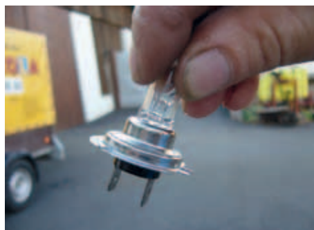
Halogenová žárovka: správná manipulace (vlevo) a chybná – skla se nesmíte dotýkat prsty (vpravo)
