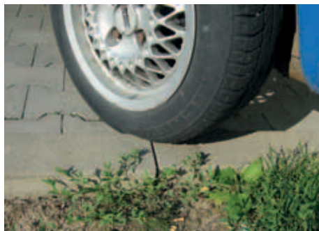
Riziko poškození pláště: špatné parkování na obrubníku
