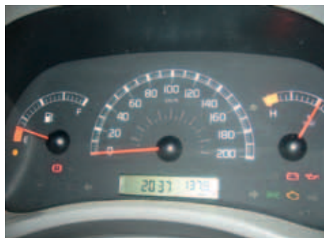
Přístrojová deska se svítícími kontrolkami pro ruční brzdu, světla, olej a akumulátor
