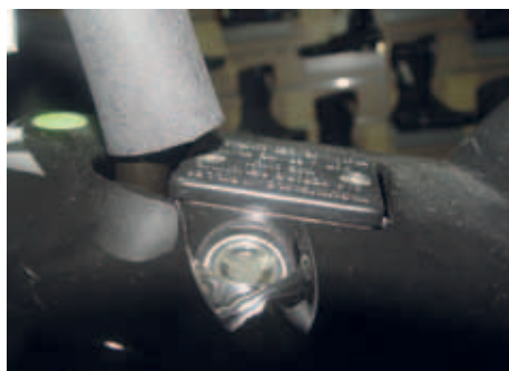
Vyrovnávací nádobka brzdové kapaliny s kontrolním okénkem jejího množství je umístěna na pravé části řídítek
