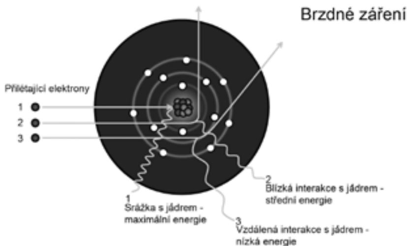
Obr. 2: Schematické znázornění vzniku brzdného záření
