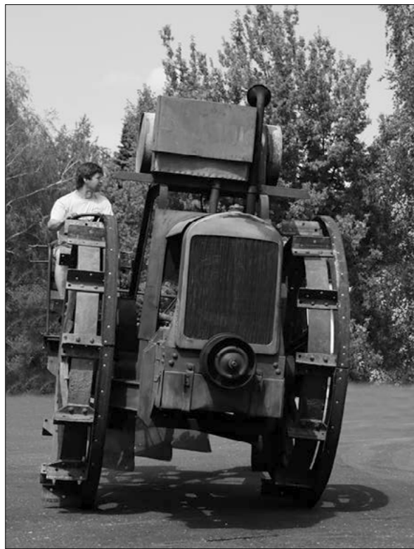
Na motorovém pluhu Excelsior P 5 je vidět rozdílné uložení hnacích kol
