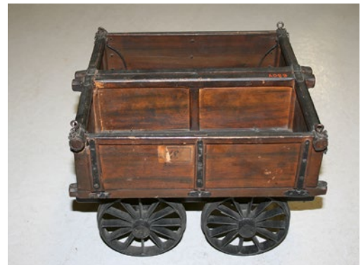
Obr. 3 Božkův model výspného vozíku pro koněspřežku (Foto NTM)
