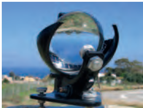
Obr. 1.12 Campbell-Stokesův slunoměr vypalující stopu v heliogramu
