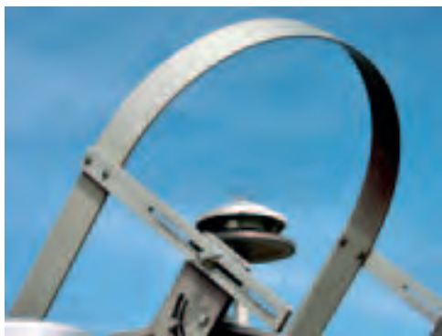
Obr. 1.11 Měření difuzního záření (stínící prstenec)
