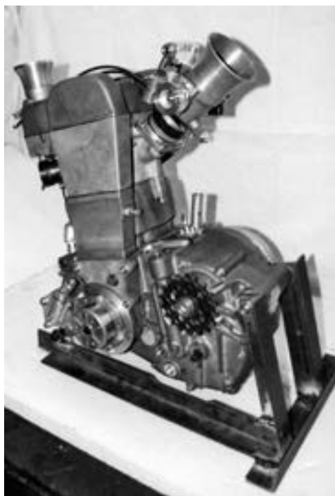
Detail nového čtyřdobého jednoválce Ahra 800 TOHC
