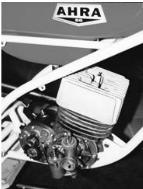
Detail vzduchem chlazeného jednoválce Ahra 50
