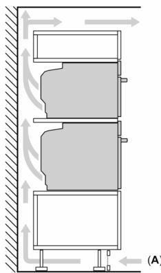
A: Otvor na prívod vzduchu  $\geq 200 \text{ cm}^2$
