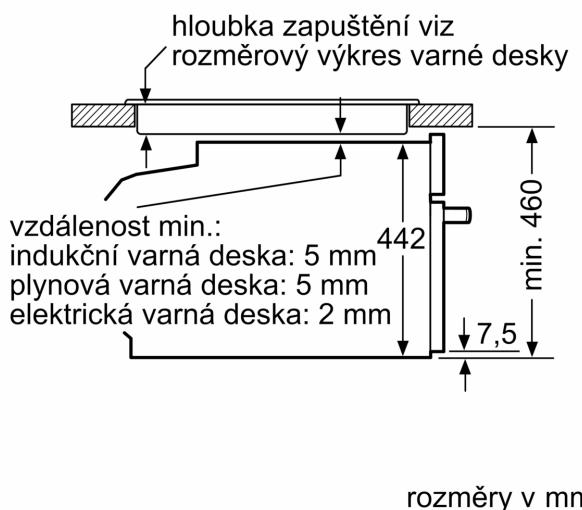
Pokud je kompaktní spotřebič vestavěný pod varnou deskou, musí být dodržena následující tloušťka pracovní desky (příp. včetně nosné konstrukce).
