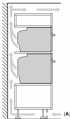
A: Otvor na prívod vzduchu  $\geq 200 \text{ cm}^2$
