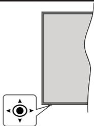
Dieser Fernseher verfügt über einen Joystick wie in der obigen Zeichnung gezeigt. Damit können Sie die Lautstärke- / Programm- / Quellen- und Standby-On-Funktionen des Fernsehgeräts steuern.
