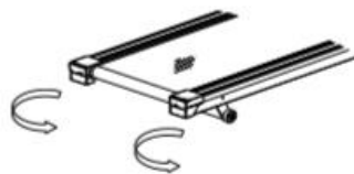
Zapnutie remeňa - skrutka proti smeru hodinových ručičiek
