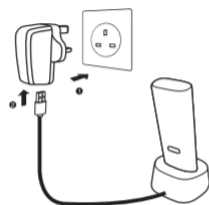
Aufladen über die Ladestation
