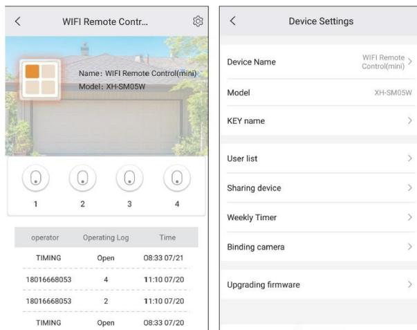
**5.1** Das Gerät ist auf einen Floating-Code für den IN-Antrieb eingestellt, der direkt mit dem Motor des Schiebe- oder Schwenktors IN arbeiten kann. Nachdem die 4 Tasten generiert wurden, siehe oben, können Sie den Lerncode verwenden, um die Schaltflächen in der App als Fernbedienung festzulegen. Setzen Sie dann die Applikationsverbindung zum Steuergerät genau wie beim klassischen Controller.
