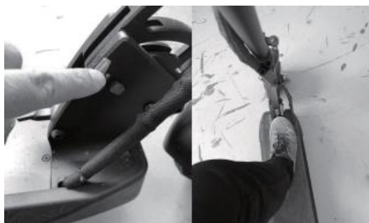
6. lépés: Oldja ki a biztonsági csapot. A roller összehajtogatásához hajtsa be a kart, és tolja előre a kormányt.
