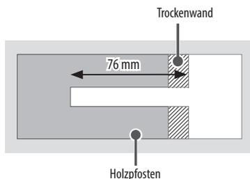
Verwenden Sie einen Ø 4 mm Bohrkopf für Holz und eine Bohrtiefe von 76 mm. (Entfernen Sie die Bohrrückstände aus den Löchern.)
