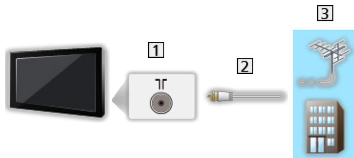
1 Anschluss für terrestrische Antenne / Kabel
