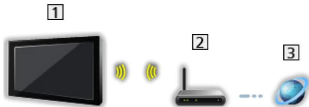
1 Integriertes Wireless-LAN (Rückseite des Fernsehers)
