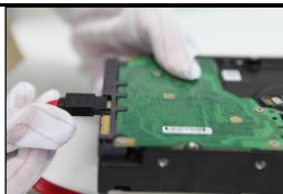
Obrázek 2-2 Připojte datový kabel
