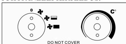
1. Vasak nupp: kütteseadega valija (ainult ventilaator, ventilaator ja ühes tükis, ventilaator ja kaks tükki)
