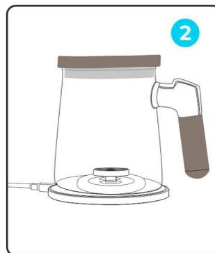
2 Po připojení napájení se na základně rozsvítí zelená kontrolka, která po dvou sekundách zhasne a zařízení přejde do pohotovostního režimu.
