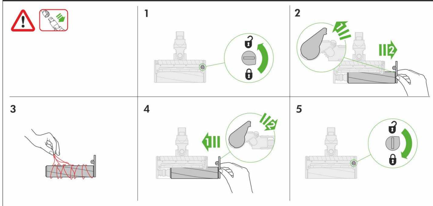
Podlahová Fluffy™ hubice s měkkým rotačním válečkem – mytí rotačních válečků •
