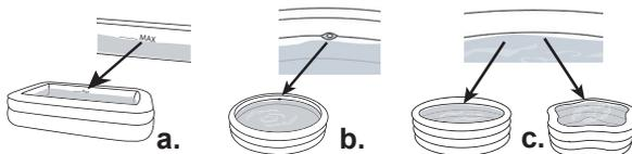
**POZNÁMKA:** Některé bazény mají odtokové otvory uprostřed stěny. Tím je zabráněno přeplnění bazénu nad doporučenou hladinu vody. Neexistují žádné zátky, nezakrývejte odtokové otvory.
