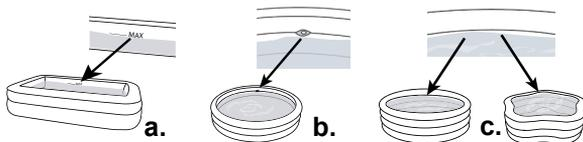
**POZNÁMKA:** Niektoré bazény obsahujú odtokové otvory v strede pozdĺž steny. Majú zabrániť preplneniu bazéna nad odporúčanú hladinu vody. Neexistujú žiadne zástrčky, nezakrývajte odtokové otvory. Obrázky majú len ilustratívny charakter. Aktuálny výrobok sa môže odlišovať. Nie je v mierke.
