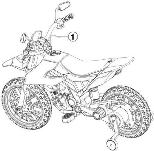
1. Stecken Sie den Ladestecker in den Ladeschlitz am Motorrad.
