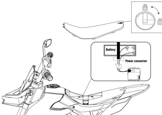
Drehen Sie den Riegel des Sitzkissens, öffnen Sie das Sitzkissen, suchen Sie das Netzkabel, schließen Sie das Netzteil an und klappen Sie das Sitzkissen wieder ein. Drehen Sie die Sitzverriegelung und sichern Sie es.
