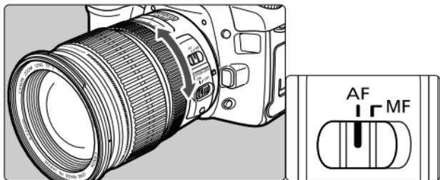
Zum Fotografieren mit automatischer Scharfeinstellung (AF) stellen Sie den Fokus-Wahlschalter auf AF (Autofokus-Modus). Für ausschließlich manuelle Scharfeinstellung (MF) stellen Sie den Fokus-Wahlschalter auf MF und fokussieren mit dem Scharfstelling. Sie können unabhängig von der gewählten Scharfeinstellbetriebsart jederzeit mit dem Scharfstelling fokussieren.
