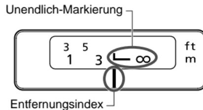
Zum Ausgleich der temperaturbedingten Verschiebung des Unendlich-Brennpunkts. Bei Normaltemperatur liegt Unendlich-Einstellung vor, wenn der senkrechte Arm der Markierung "L" mit dem Einstellindex fluchtet.
