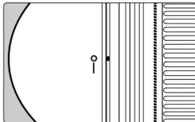
Zum Aufsetzen fluchten Sie zunächst die Ansetzmarkierung der Gegenlichtblende mit dem roten Punkt vorn am Objektiv. Drehen Sie dann die Blende in Pfeilrichtung, bis sich der rote Punkt am Objektiv mit der Anschlagmarkierung der Gegenlichtblende deckt.
