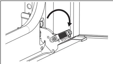
3. Schließen Sie die Backofentür halb bis zur ersten Öffnungsstellung. Anschließend heben und ziehen Sie die Tür aus der Aufnahme heraus.
