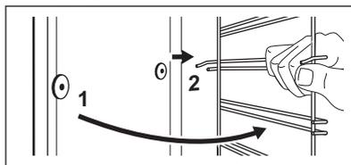
4. Setzen Sie die Einhängegitter in umgekehrter Reihenfolge ein. Wenn die Teleskopschienen mitgeliefert werden, müssen ihre Haltestifte nach vorne zeigen.
