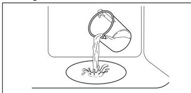
Die maximale Kapazität der Garraumvertiefung beträgt 250 ml. Füllen Sie die Garraumvertiefung nicht wieder auf, während der Garvorgang läuft oder das Gerät heiß ist.
