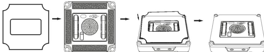
Odklopte silikonovou krytku zásobníku na vodu (7) a nalejte s pomocí přiložené plastové nádoby do zásobníku čistou vodu. Nepřepiňujte zásobník na vodu (naplnění na 80 % je dostačující), aby byl zachován stabilní tlak vzduchu.
