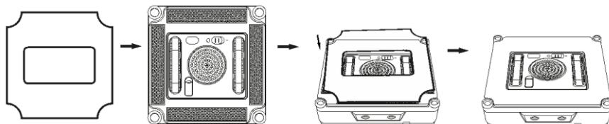
Desfaceți capacul din silicon al rezervorului de apă (7) și turnați apă curată în rezervor folosind recipientul de plastic inclus. Nu umpleți excesiv rezervorul de apă (umplerea 80% este suficientă) pentru a menține o presiune stabilă a aerului.
