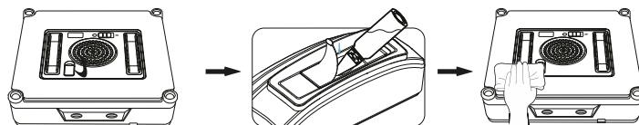
Zariadenie používajte iba s čistou destilovanou vodou, aby nedošlo k vytváraniu vodného kameňa a upchatiu vodných trysiek. Nepridávajte žiadne čistiacie prostriedky, ktoré môžu spôsobiť napenenie, šmuhy alebo zanesenie vodných trysiek. Pokiaľ to stav znečistenia okna vyžaduje, môžete použiť na navlhčenie čistiacej tkaniny alebo plochy okna malé množstvo kvalitného, nepenivého prostriedku s nízkym obsahom alkoholu na umývanie okien.
