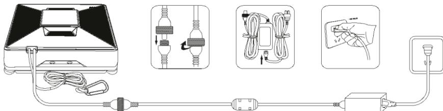
Zamontuj linkę zabezpieczającą w odpowiednim miejscu i wyreguluj jej długość tak, aby zabezpieczyć urządzenie przed upadkiem. Upewnij się, że długość kabla lub liny nie ogranicza ruchu urządzenia na oknie.
