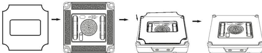
Rozłoż silikonową pokrywkę zbiornika na wodę (7) i wlej do zbiornika czystą wodę za pomocą dołączonego plastikowego pojemnika. Nie przepełniaj zbiornika na wodę (wystarczy napełnienie w 80%), aby utrzymać stabilne ciśnienie powietrza.
