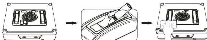
Zařízení používejte pouze s čistou destilovanou vodou, aby nedošlo k vytváření vodního kamene a ucpání vodních trysek. Nepřidávejte žádné čistící prostředky, které mohou způsobit napěnění, šmouhy nebo zanesení vodních trysek. Pokud to stav znečištění okna vyžaduje, můžete použít k navlhčení čistící tkaniny nebo plochy okna malé množství kvalitního, nepěnivého prostředku s nízkým obsahem alkoholu na mytí oken.
