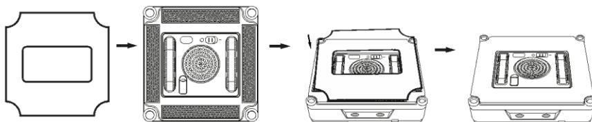
Hajtsa ki a víztartály szilikon fedelét (7), és öntsön tiszta vizet a tartályba a mellékelt műanyag edény segítségével. A stabil légyomás fenntartásához ne töltse túl a víztartályt (80%-os töltés elegendő).
