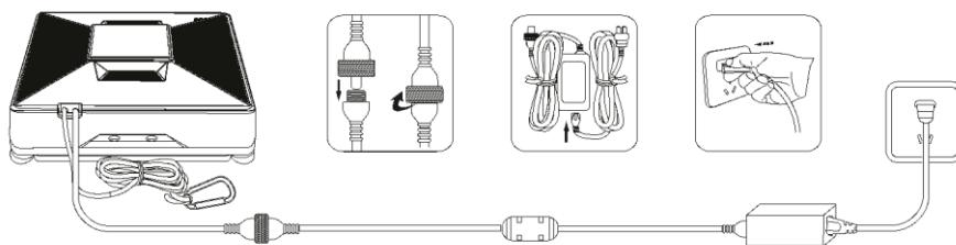
Installieren Sie an geeigneter Stelle ein Sicherungsseil und passen Sie dessen Länge an, um das Gerät gegen Herunterfallen zu sichern. Stellen Sie sicher, dass die Länge des Kabels oder Seils die Bewegung des Geräts auf dem Fenster nicht einschränkt.
