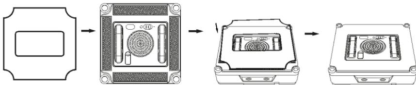
Klappen Sie den Silikondeckel des Wassertanks (7) auf und füllen Sie mit dem beiliegenden Kunststoffbehälter sauberes Wasser in den Tank. Überfüllen Sie den Wassertank nicht (80 % Füllung sind ausreichend), um einen stabilen Luftdruck aufrechtzuerhalten.
