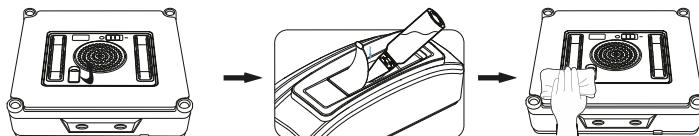
Benutzen Sie das Gerät nur mit reinem destilliertem Wasser, um Kalkablagerungen und Verstopfungen der Wasserdüsen zu vermeiden. Fügen Sie keine Reinigungsmittel hinzu, die zu Schaumbildung, Verschmieren oder Verstopfen der Wasserdüsen führen können. Wenn es der Verschmutzungszustand des Fensters erfordert, können Sie das Reinigungstuch oder die Fensteroberfläche mit einer kleinen Menge eines hochwertigen, nicht schäumenden Fensterreinigers mit niedrigem Alkoholgehalt anfeuchten.
