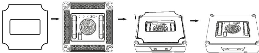
Odklopte silikónový kryt zásobníka na vodu (7) a nalejte s pomocou priloženej plastovej nádoby do zásobníka čistú vodu. Neprepĺňujte zásobník na vodu (naplnenie na 80 % je dostačujúce), aby bol zachovaný stabilný tlak vzduchu.
