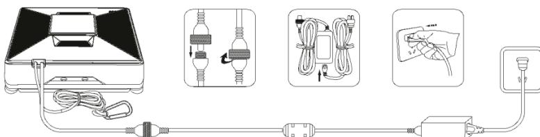
Instalați un cablu de siguranță într-un loc adecvat și reglați-l lungimea pentru a asigura dispozitivul împotriva căderii. Asigurați-vă că lungimea cablului sau a frânghei nu restricționează mișcarea dispozitivului pe geam.
