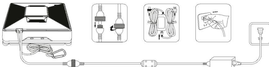
Szereljen fel egy biztonsági kábelt egy megfelelő helyre, és állítsa be a hosszát, hogy biztosítsa a készüléket leesés ellen. Ügyeljen arra, hogy a kábel vagy kötél hossza ne korlátozza a készülék mozgását az ablakon.
