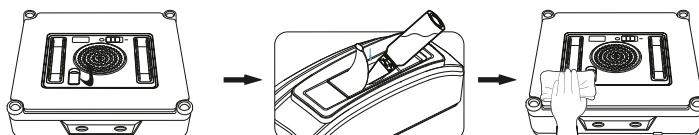
Używaj urządzenia wyłącznie z czystą wodą destylowaną, aby uniknąć osadzania się kamienia i zatykania dysz wodnych. Nie dodawać żadnych środków czyszczących, które mogą powodować pienienie, rozmazywanie lub zatykanie dysz wodnych. Jeśli wymaga tego stan zabrudzenia okna, można za pomocą niewielkiej ilości dobrej jakości, niepieniącego się środka do mycia szyb o niskiej zawartości alkoholu zwilżyć ścierczkę lub powierzchnię okna.
