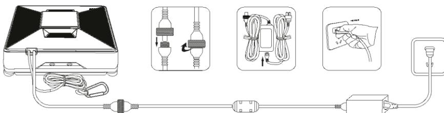
Nainstalujte na vhodné místo bezpečnostní lanko a přizpůsobte jeho délku k zajištění zařízení proti pádu. Ujistěte se, že délka kabelu ani lana neomezuje pohyb zařízení na okně.
